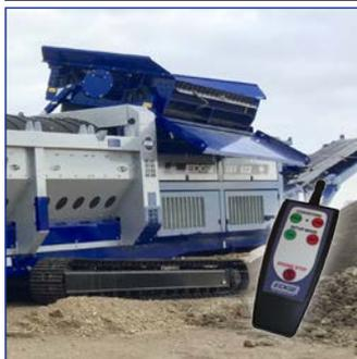
Rejilla vibrante del piso doble con la función remota de inclinación.
