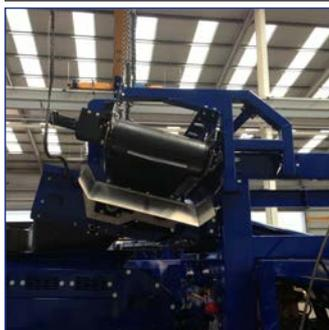
Magneto de banda montado en el transportador de recogida para extraer metales ferrosos
