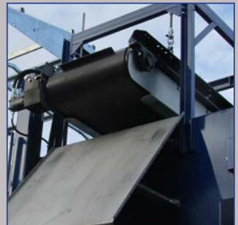
Imán de banda de sección de cabeza con canal de acero inoxidable para extraer metales ferrosos
