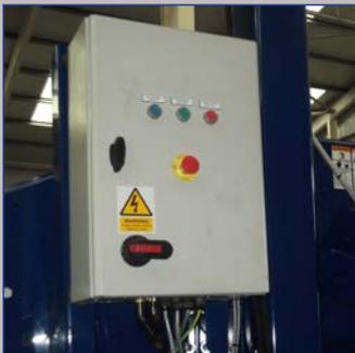
Panel eléctrico disponible con ajuste de velocidad, relé de parada de emergencia y circuito de sirena de pre-arranque
