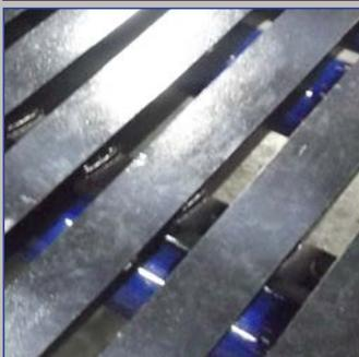
Medio de Barra Bofor con apertura diferente para cribado de pesados de cribado pesado.
