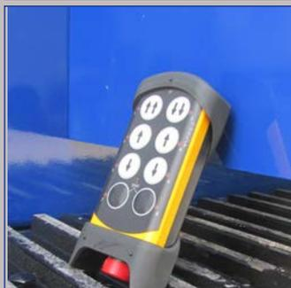
Seguimiento remoto, aumento/disminución de revoluciones del motor y ajuste del tambor de división.
